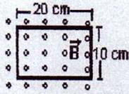
10 espiras rectangulares de resistencia  $R = 2,0 \Omega$ , están colocadas en una zona de campo magnético B variable. Inicialmente el flujo magnético para las espiras es de  $50 \times 10^{-3} \text{ Wb}$ ,
