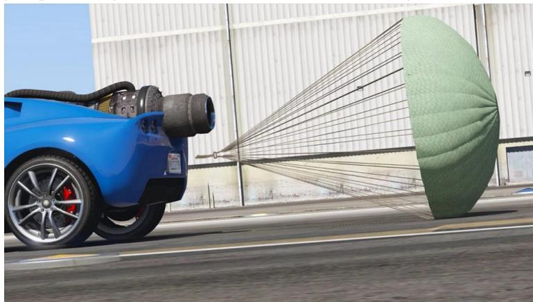
Fig.8.25 Paracaídas de frenado en un auto
