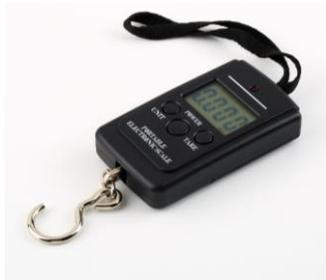
Fig. 1.03 Dinamómetro digital
