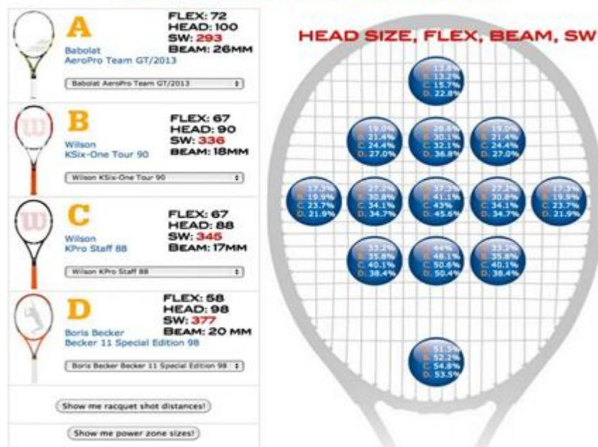
Fig. 6.45 Porcentaje de restitución de la velocidad en diversos puntos de la raqueta
