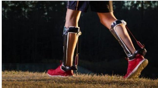
Fig. 6.31 Exoesqueleto elástico para caminar
