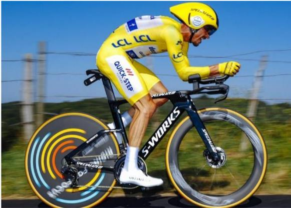
Los cascos aerodinámicos buscan evitar la formación de torbellinos, de vórtices tras la región posterior de la cabeza, lo que generaría una zona de baja presión dificultando el avance. La rueda lenticular (enteriza) también busca disminuir la turbulencia generada por el propio ciclista..
